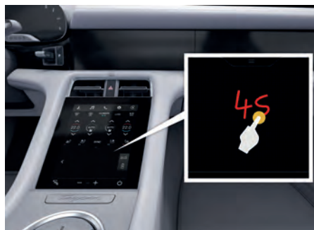
図. 152 センター コンソール コントロール パネルの手書き入力
