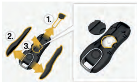
図. 7 バッテリーの交換
