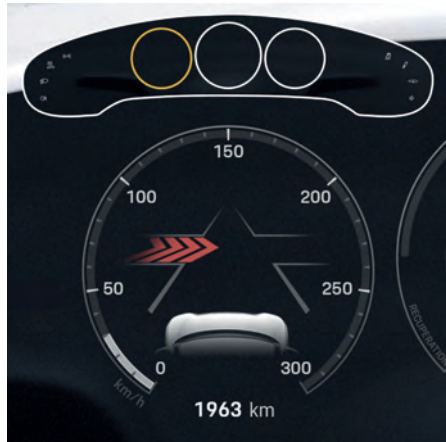
図. 106 インストルメントクラスターのインターセクションアシストディスプレイ
