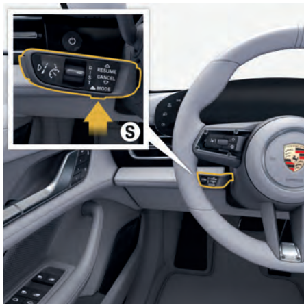
図. 97 ドライバー アシスタンス システムのコントロールレバー
