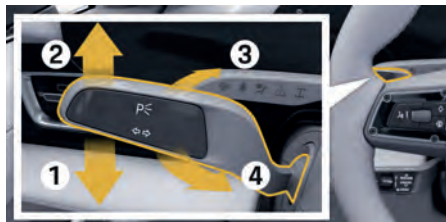
図. 110 方向指示灯、ハイビーム、およびヘッドライトパッシングの操作
