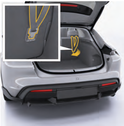
図. 49 i-Size または ISOFIX トップテザー付きチャイルドシートの固定
