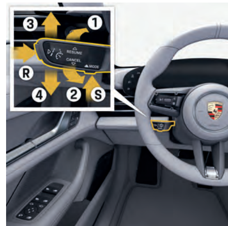
図. 137 ドライバーアシスタンスシステムのコントロールレバー
