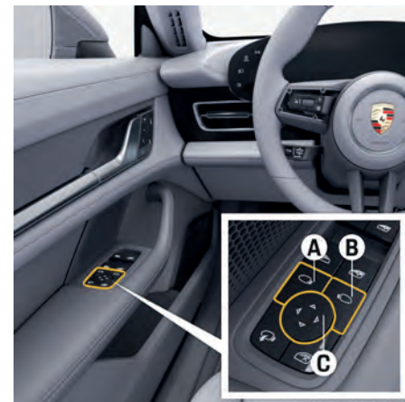
図. 85 パーキング エイドとしてのミラー ガラスの下向き切り替え
