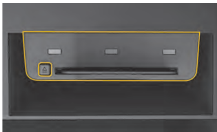
図. 168 グローブボックス内の ETC カードリーダー
