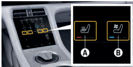
図. 77 シートヒーター/シートベンチレーターのON/OFFの切り替え
