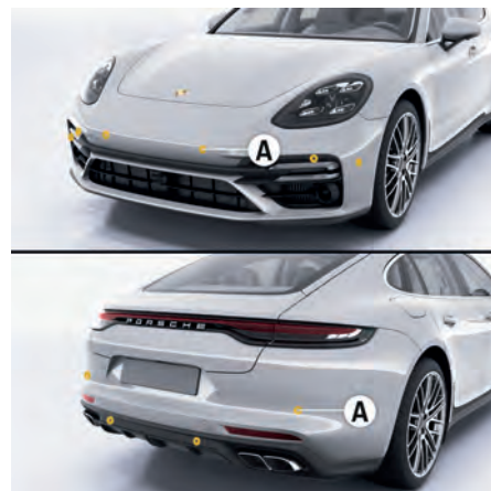
図. 112: 距離測定用超音波センサー
