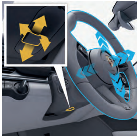
図. 71: ステアリングホイール調節用スイッチ
