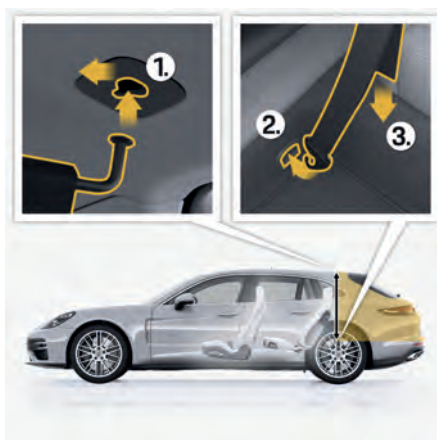
図. 202: フロントのラゲッジコンパートメントパーテーションネットの取り付け
