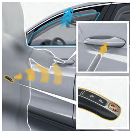
図 17: ドアハンドルの近接センサーでウィンドウを閉じる
