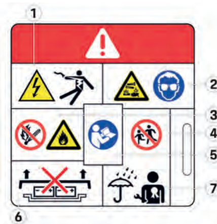
図. 2: 高電圧バッテリーの警告サイン
