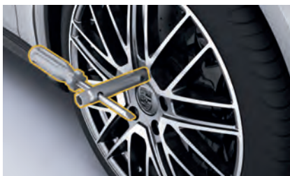
図. 225: PCCB 非装備車には、組み付け補助工具を 1 つねじ込みます
