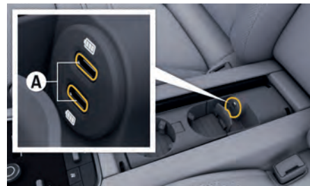
図. 157: リヤセンターアームレスト内の USB インターフェイス (タイプ C)
