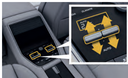
図. 62: リアの温度および風量の設定 (4ゾーンエアコン)
