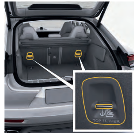
図. 55: リヤシート 3 席装備車： ISOFIX リテーニング ラグ (トップテザー) の固定位置
