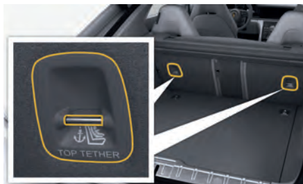
図. 54: リヤシート 2 席装備車： ISOFIX リテーニング ラグ (トップテザー) の固定位置
