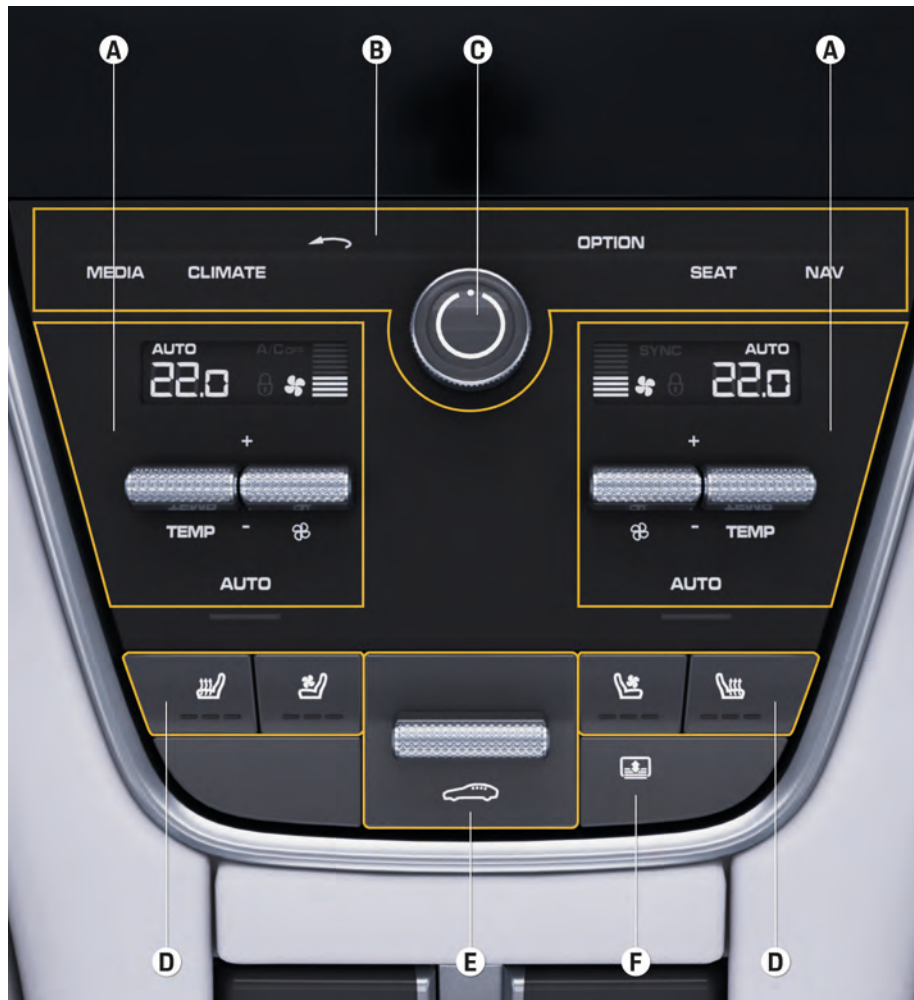
図. 10. リヤコントロールパネル
