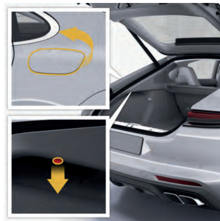
図. 219: 充電ポートリッドの緊急解除の実行
