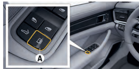
図. 231: ボタン A：燃料タンクベンチレーションを開始し、フィルターフラップを開く
