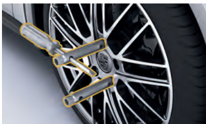
図. 226: PCCB 装備車には、組み付け補助工具を 2 つねじ込みます
