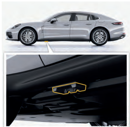
図. 235: フロント側のリフティングプラットフォームおよびジャッキのジャッキアップポイント
