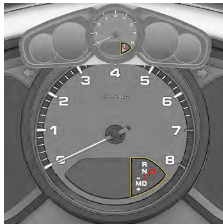
図. 101: インストルメント クラスタ内のモードおよび締結ギヤインジケーター
