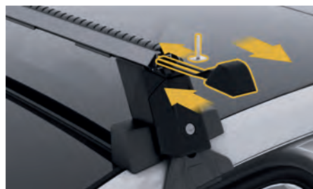
図. 179: カバートリムをサイズに合わせて切り、押し込む
