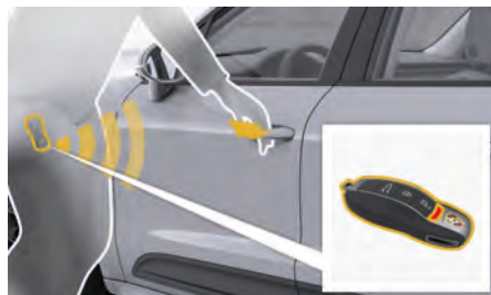
図. 36: ポルシェ エントリー&ドライブを使用したドアのロック解除
