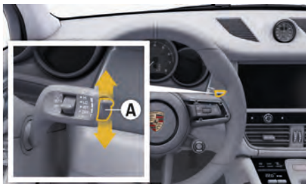
図 138: レインセンサー/間欠作動感度の切り替えスイッチ
