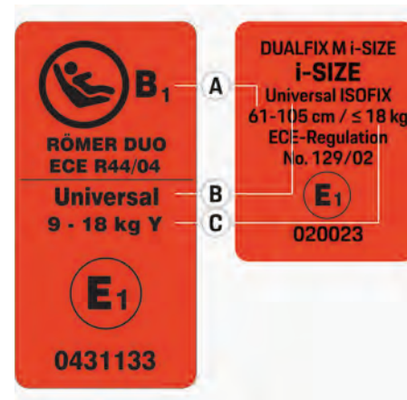
図. 50: チャイルドシートの ECE ラベルの例
