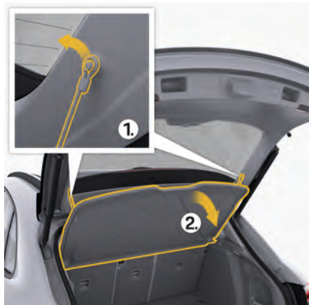
図. 196: ラゲッジコンパートメント カバーの取り外し
