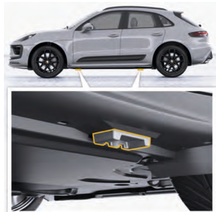
図 234: リフティングプラットフォームおよびジャッキのジャッキアップポイント
