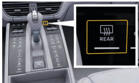
図. 70: フロントウィンドウ/リヤウィンドウ/ドアミラーヒーター
