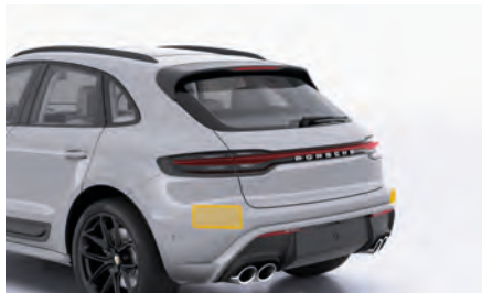
図 147: リヤバンパーのレーダーセンサー
