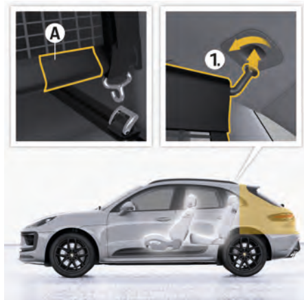
図. 208: ルーフのラゲッジコンパートメントパーテーションネットの取り付け
