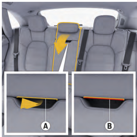
図. 82: 中央のリヤシートバックレストを前方に倒す
