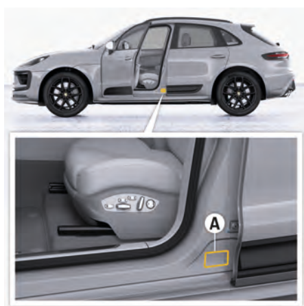
図. 220: タイヤ空気圧プレートの記載箇所
