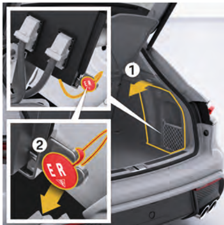
図 233: フィラー フラップの緊急ロック解除の実行
