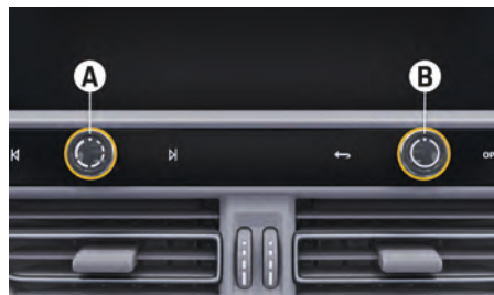
図. 157: PCM ロータリー プッシュ ボタンおよびボリュームスイッチ
