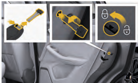
図. 40: 右リアドアのチャイルドロック
