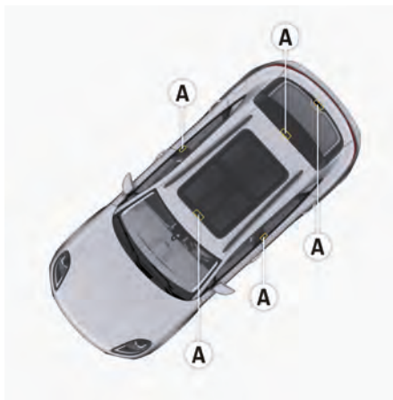
図. 43: ラジオ アンテナの取り付け位置
