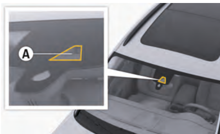
図. 140: フロントウィンドウフロントカメラ
