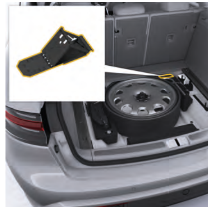
図. 235: 輪止めの取り外し
