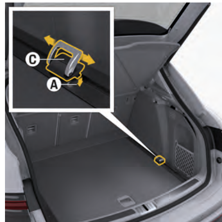
図. 207: タイダウンリングの移動
