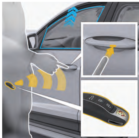
図 21: ドアハンドルの近接センサーでウィンドウを閉じる
