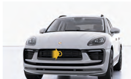
図. 100: レーダー センサーの取り付け位置
