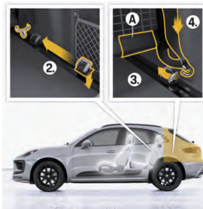
図. 209: ラゲッジコンパートメントフロアでのラゲッジコンパートメントパーテーションネットの取り付け
