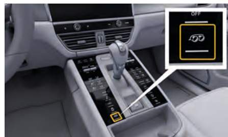
図 114: センターコンソールのスポーツエキゾーストシステム操作ボタン
