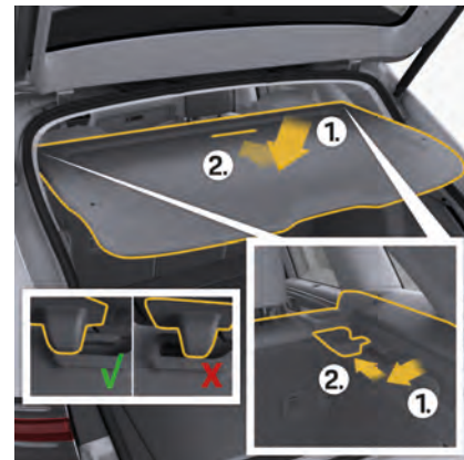
図. 198: ラゲッジコンパートメント カバーの挿入
