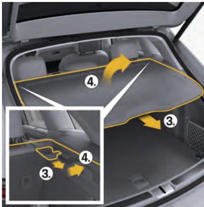
図. 197: ラゲッジコンパートメント カバーの取り外し
