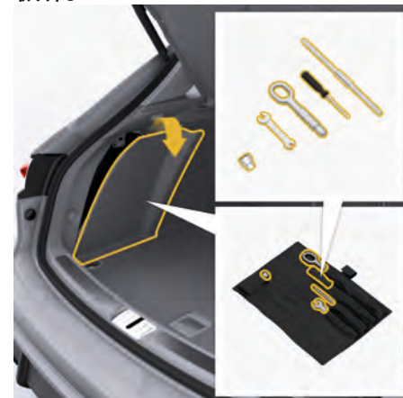
図. 192: 工具セット (コラプシブルスペア ホイールを除く) の取り外し
