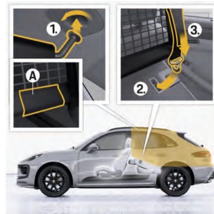
図. 210: 折りたたみリヤシートバックレスト付きラゲッジコンパートメントパーテーションネットの取り付け
