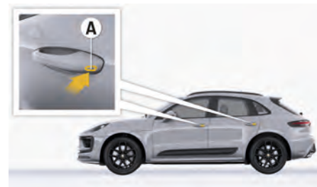
図. 38: ポルシェ エントリー&ドライブを使用したドアのロック
