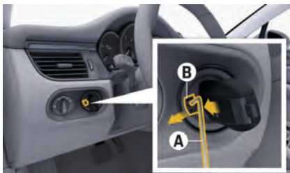
図. 16: イグニッションロックからのプラスチックカバーの取り外し
