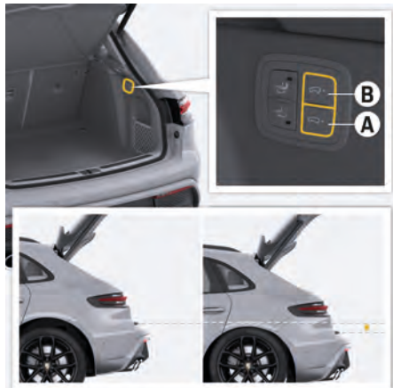
図. 133: ラゲッジコンパートメントのボタンによるローディングレベル機能の設定
