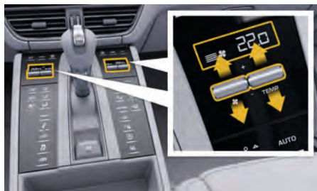
図. 64: フロントのエアコンコントロールパネルの温度と風量の設定
