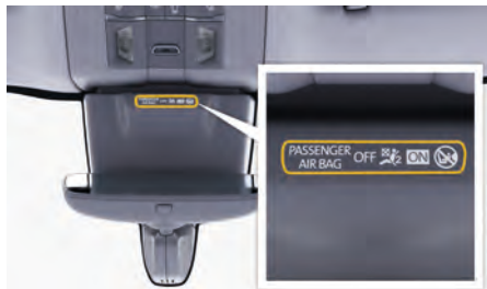
図. 44: 助手席エアバッグ OFF/ON インジケーター
