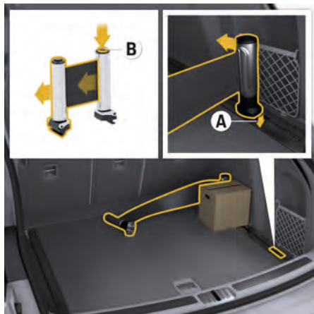
図. 205: レールにストラップリールを挿入
