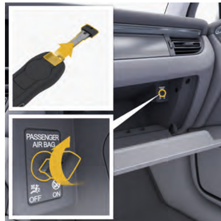
図. 53: 助手席エアバッグを OFF にする
