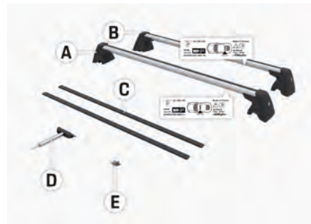
図. 180: ルーフトランスポートシステムの構成部品
