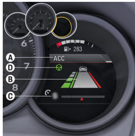
図 144: 車線逸脱警告の表示
