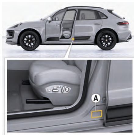
図. 238: タイヤ空気圧プレートの記載箇所
