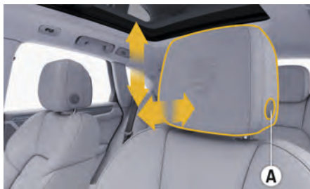
図. 83: フロントシートのヘッドレストの高さと前後位置の調節
