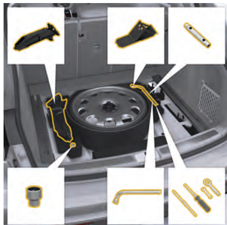
図. 193: 工具セット (コラプシブルスペアホイールを含む) の取り外し
