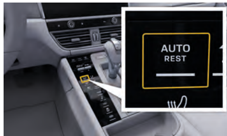
図. 71: REST モードの作動および停止
