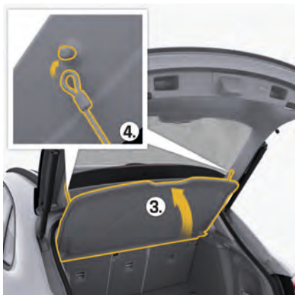
図. 199: ラゲッジコンパートメントカバーの取り付け
