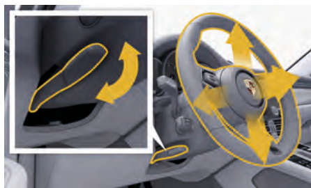
図. 72: ステアリングホイール調節用ロックレバー
