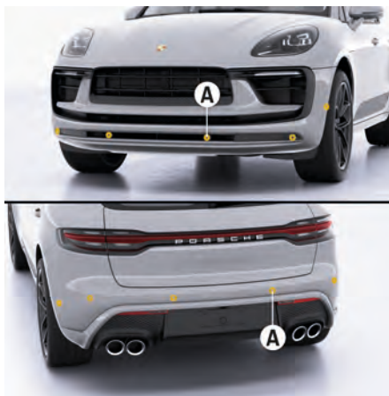
図. 125: 距離測定用超音波センサー
