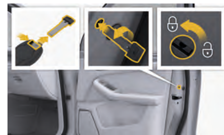
図. 42: 助手席ドアの緊急ロック
