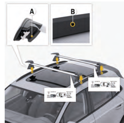
図. 183: キャリアをルーフレール上に位置決めし、位置を合わせます
