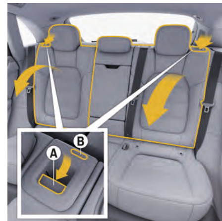
図 81: 外側リヤシートのバックレストを前方に倒す
