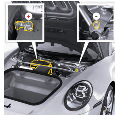
図. 233: 鉛蓄電池端子
