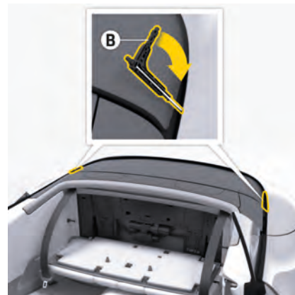
図 50: コンバーチブルトップコンパートメント リッドのロック解除 (手順 1)
