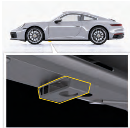
図. 280: ジャッキおよびリフティングプラットフォーム用のフロント側リフティングポイント
