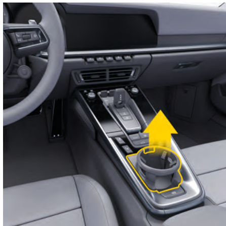
図. 215: ドリンクホルダーのセンターコンソールからの取り外し
