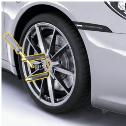
図. 251: PCCB 装備車には、組み付け補助工具を 2 つねじ込みます
