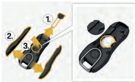
図. 10: バッテリーの交換
