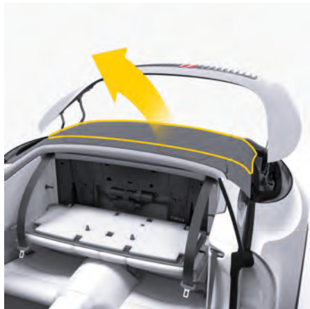
図. 56: コンバーチブルトップを格納コンパートメントから引き出す
