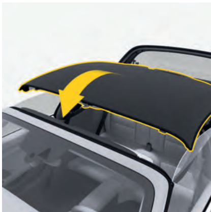
図. 35: コンバーチブルトップエレメントを前方に引く
