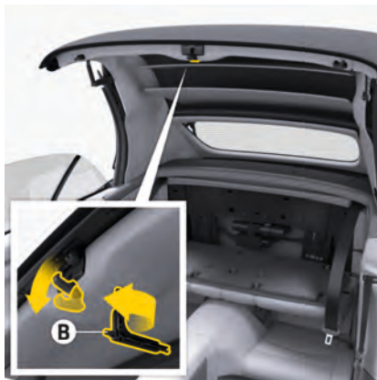
図. 58: コンバーチブルトップラッチフックの展開
