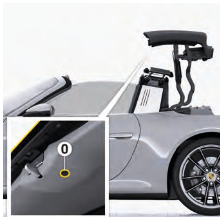
図. 33: ルーフキャッチ緊急操作アクセスポイントからのプラグの取り外し
