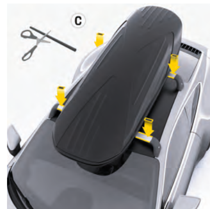
図. 213: カバートリムをサイズに合わせて切り、取り付ける
