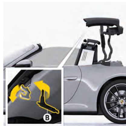
図. 34: コンバーチブルトップラッチフックの展開
