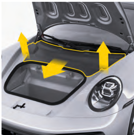
図. 220: プラスチック カバーの解除と引き上げ
