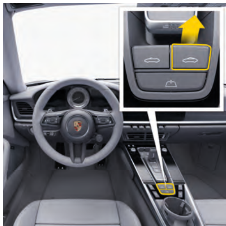
図 40: ボタンによるコンバーチブルトップの開操作
