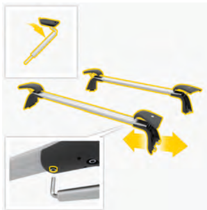
図. 208: キャリアの下側のスクリーンをゆるめます。
