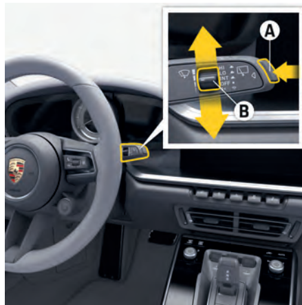
図. 155: リヤワイパー用のボタンAおよびレインセンサー感度のスイッチB
