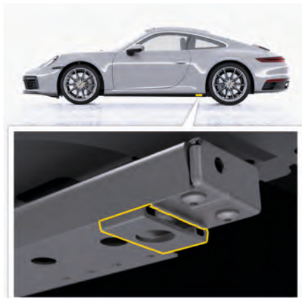
図. 281: ジャッキおよびリフティングプラットフォーム用のリヤ側リフティングポイント
