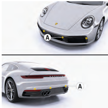
図. 149: 距離測定用超音波センサー
