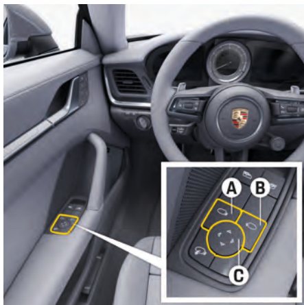
図. 116: パーキング エイドとしてのミラー ガラスの下向き切り替え
