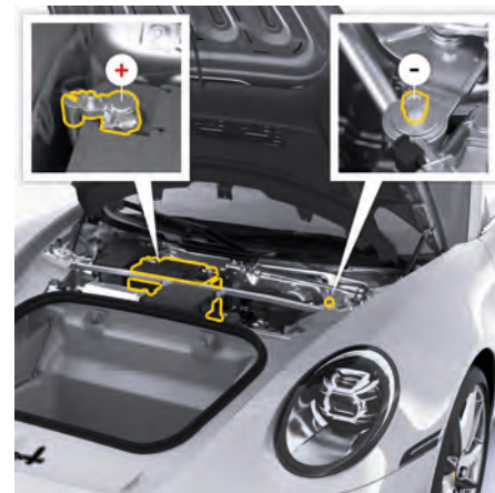
図. 230: 鉛蓄電池端子
