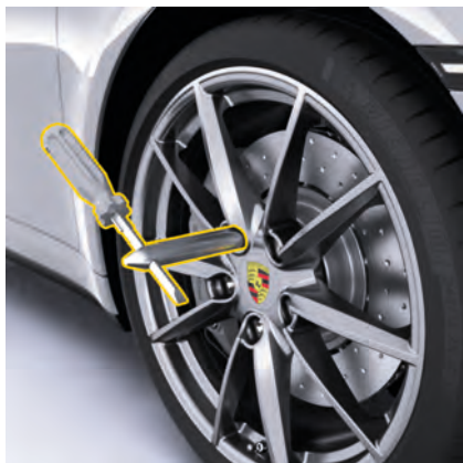
図. 250: PCCB 非装備車には、組み付け補助工具を 1 つねじ込みます
