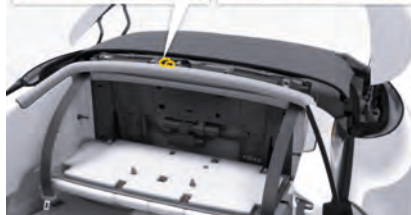
図. 54: スクリューをゆるめてモーター / ギヤユニットを前方に引く
