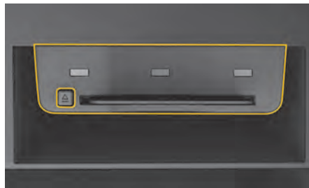
図. 194: グローブボックス内の ETC カードリーダー
