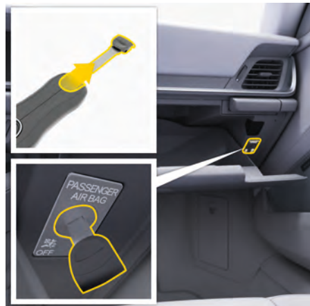
図. 80: 助手席エアバッグを OFF にする
