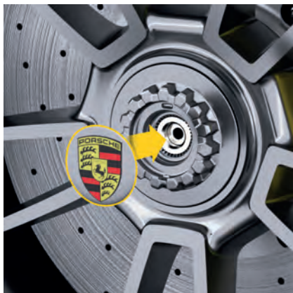
図. 269: カバー キャップの取り付け
