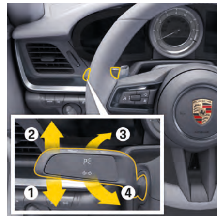
図. 144: 方向指示器、ハイビーム、およびヘッドライトパッシングの操作
