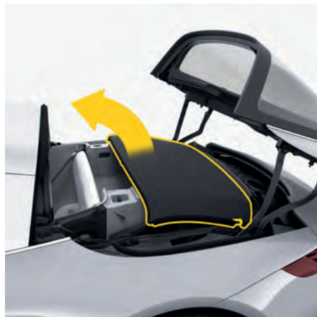
図. 32: コンバーチブルトップエレメントを閉じる
