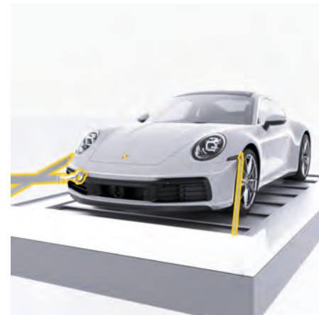
図. 238: 車両をフラットベッドに固定する
