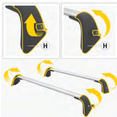
図. 207: カバー フラップのロック解除および持ち上げ
