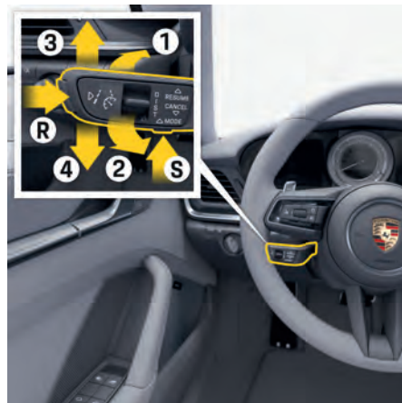
図. 169: ドライバー アシスタンス システムのコントロールレバー
