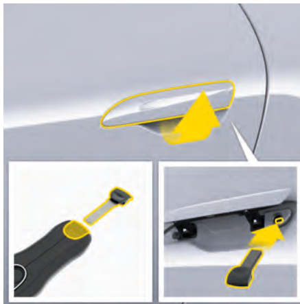
図. 68: 緊急ロック解除 / 緊急ロックの実行
