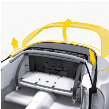
図. 52: コンバーチブルトップコンパートメントリッドの上昇
