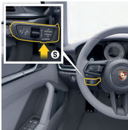
図. 128: ドライバー アシスタンス システムのコントロールレバー
