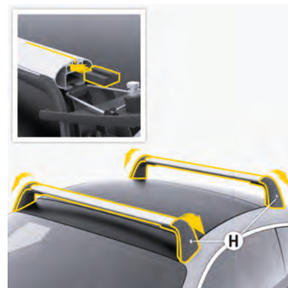
図. 212: 積載機器の挿入
