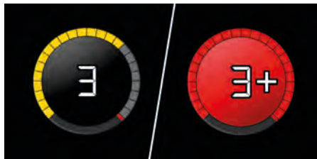
図. 174: ギヤシフトアシスト/ギヤのシフトアップの例
