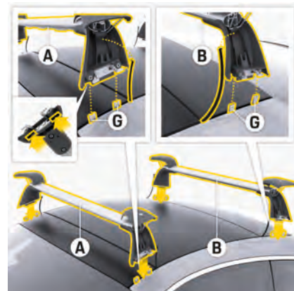
図. 209: キャリアの長さを調節する
