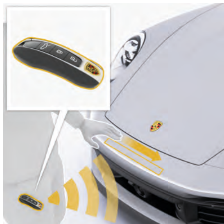
図 17: コンフォートアクセスでラゲッジコンパートメント リッドを開く
