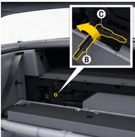
図 27: ルーフドライブメカニズムの解除
