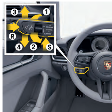
図 121: ドライバー アシスタンス システムのコントロールレバー
