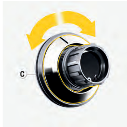
図. 259: コーンリングの点検
