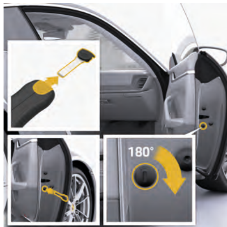
図. 69: 助手席ドアの緊急ロック
