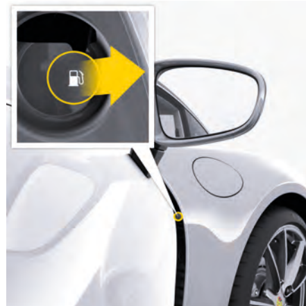
図. 279: 緊急時のフィラー フラップの操作
